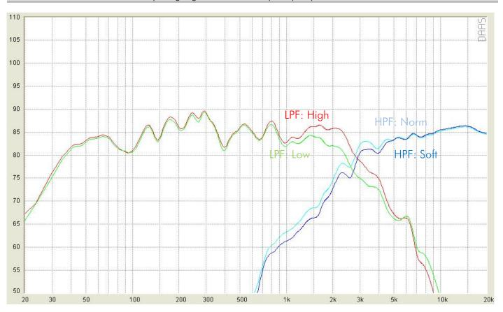
\*Der Bereich unterhalb von 300Hz wird von Raum und Gehäuse beeinflusst.
